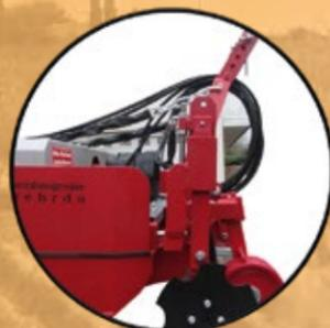
Mit hydraulischer höhen und Tiefeneinstellung der Seitenanbaugeräte
