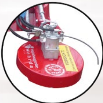
Schwinkscheibe mit beweglichen Messern, hydraulisch angetrie- ben und mit hydraulischer Abtastung
