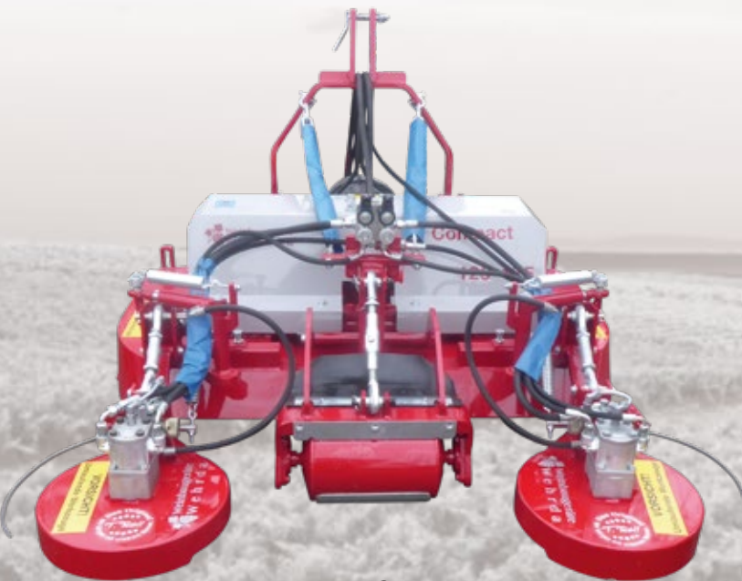
Mulchgerät Compact TF mit Unterstockschwenscheiben mit hydraulischem Antrieb und hydraulischer Abtastung
