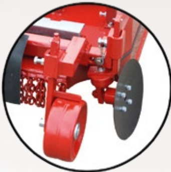
Mulchgerät mit fest- stehenden Rädern, Trägerführungsrohr und Pflugscheiben glatt
