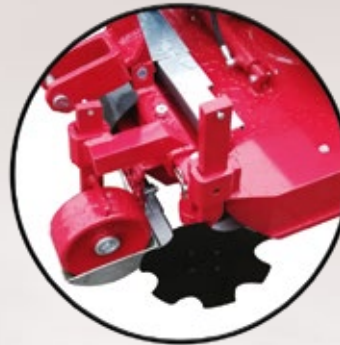
Mulchgerät mit fest- stehenden Rädern, Trägerführungsrohr und Pflugscheiben gezackt
