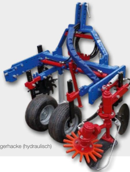
Geräterahmen „Eco“ mit Stock-Kopier-Gerät und Fingerhacke (hydraulisch)
