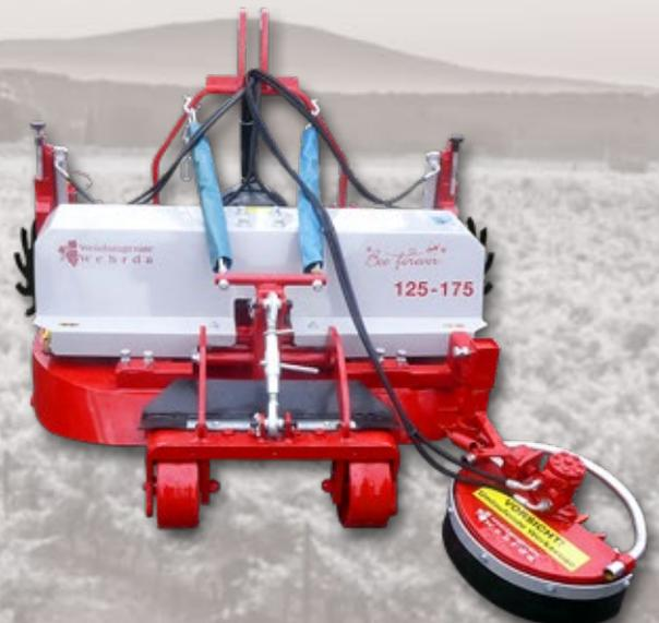
Mulchgerät Compact „Bee Forever“ mit Fingerhacke und Senkrechtaushebung
